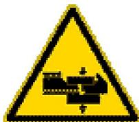
Il cesoiamento e lo stritolamento di persone tra parti mobili di macchine e parti fisse delle medesime o di opere, strutture provvisorie o altro, deve essere impedito limitando con mezzi materiali il percorso delle parti mobili o segregando stabilmente la zona pericolosa.
