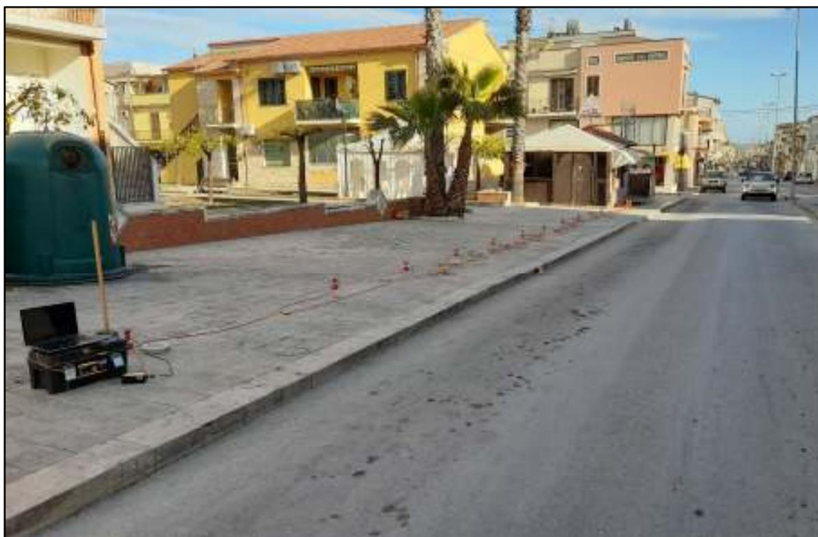
La prova sismica MASW (*Multichannel Analysis of Surface Wave*) consente di determinare l'andamento della velocità delle onde di taglio (*Onde S*) nel sottosuolo mediante l'analisi della dispersione delle onde superficiali o Onde di Rayleigh nel dominio del tempo.
