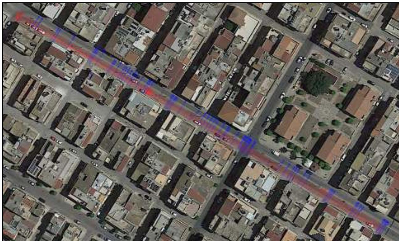
L'indagine realizzata con unità di acquisizione *IDS Opera Duo* dotata di due antenne con frequenze principali da 250 e 700 MHz ha permesso la mappatura dei sottoservizi che sono stati segnati direttamente in cantiere con vernice spray per tracce indicandone le profondità e la direzione.
